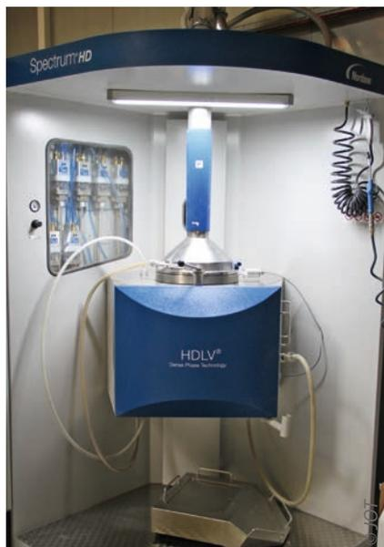
Das neue Pulverzentrum mit geschlossenem Pulverkreislauf ist als Zentraleinheit mit automatisierten Reinigungsprogrammen konzipiert
