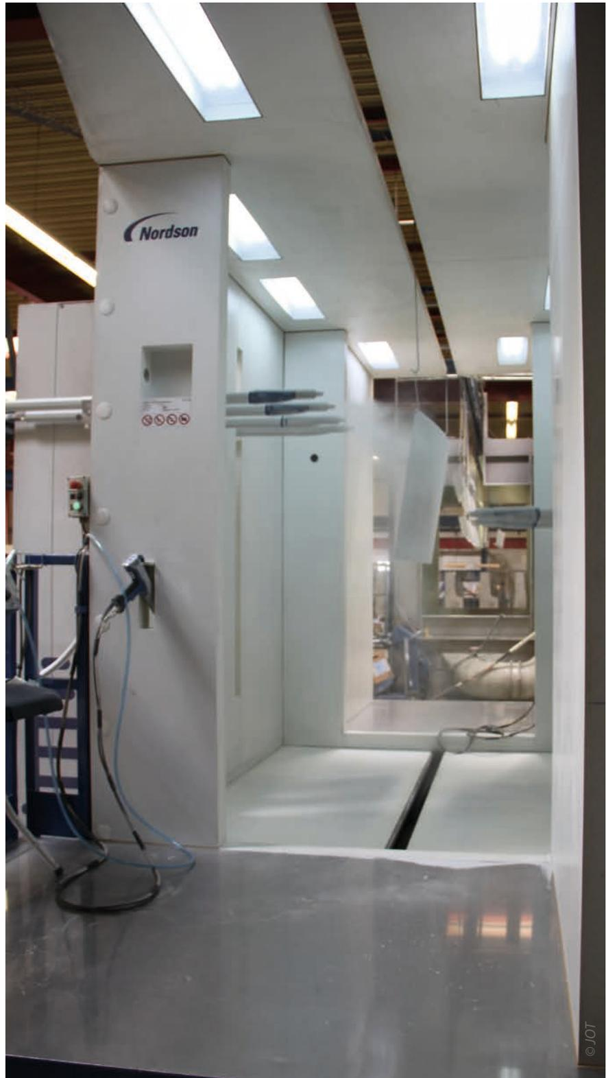
Acht Automatikpistolen sorgen in der Schnellfarbwechsellkabine für einen hohen Auftragswirkungsgrad und ein gleichmäßiges, wiederholbares Sprühmuster.
