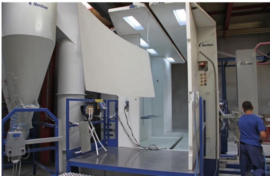
Eine Dichtstrom-Transfer-Pumpe entleert den Zyklontrichter, führt das wieder gewonnene Pulver zum Pulverzentrum zurück und ermöglicht einen automatischen Farbwechsel ohne Demontage
