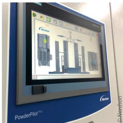
Die Prozessabläufe werden über eine digitale, windowsbasierende Touchscreen-Steuerung geregelt, die auf Basis von Piktogrammen arbeitet
