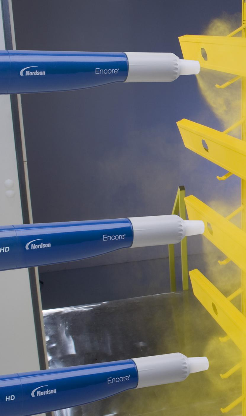
Durch Encore<sup>HD</sup> Beschichtungssysteme profitieren die Anwender von zahlreichen Vorteilen:
